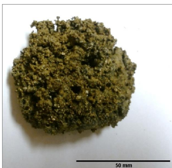
รูปที่ 1 แสดงลักษณะของขี้เถ้าที่เกิดการเผาไหม้แล้วจับตัวเป็นก้อน
