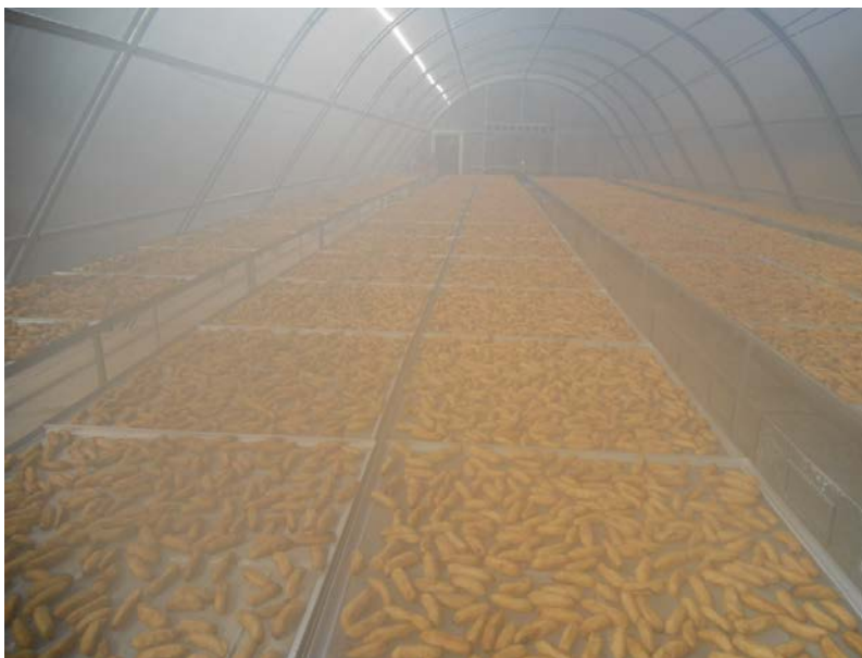
รูปที่ A1.3 หมอกที่เกิดภายในโรงอบแห้งเมื่อความชื้นสัมพัทธ์ภายในโรงอบสูงเกินไป
