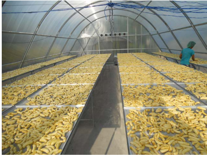
รูปที่ A1.6 กล้วยเล็บมือนางที่วางบนตะแกรงในโรงอบ
