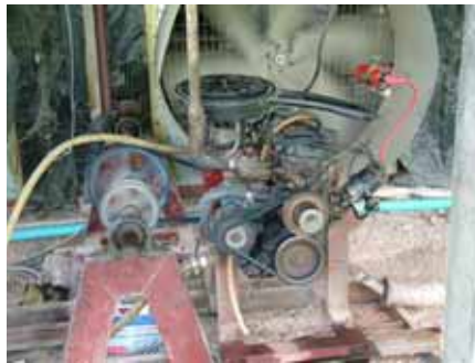
รูปที่ 5-41 เครื่องยนต์ขับเคลื่อนที่ไม่มีครอบป้องกัน
