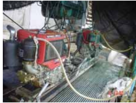
รูปที่ 3-32 การนำก๊าซชีวภาพไปใช้กับเครื่องยนต์ดีเซลขนาดเล็กแบบเชื้อเพลิงคู่
