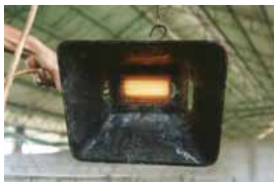
รูปที่ 5-40 หัวกกกลูกสุกรที่ดัดแปลงให้ใช้กับก๊าซชีวภาพแล้ว
