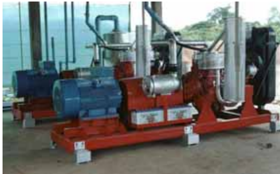
รูปที่ 3-34 เครื่องยนต์ดีเซลดัดแปลงให้ใช้ก๊าซชีวภาพแทนได้ทั้งหมดต่อร่วมกับ Synchronous/Induction Generator เพื่อผลิตไฟฟ้า
