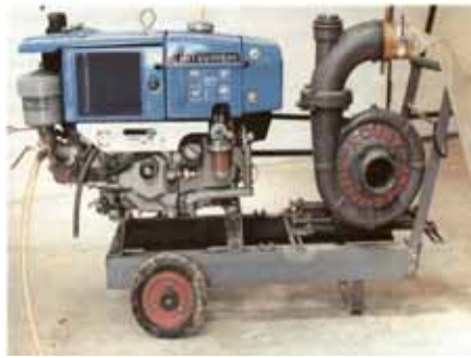
รูปที่ 3-32 การนำก๊าซชีวภาพไปใช้กับเครื่องยนต์ดีเซลขนาดเล็กแบบเชื้อเพลิงคู่
