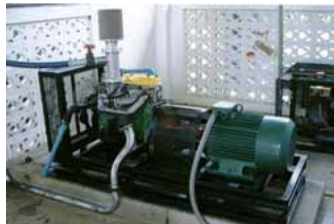
รูปที่ 3-33 เครื่องยนต์เบนซินดัดแปลงให้ใช้ก๊าซชีวภาพได้ 100 % ต่อร่วมกับ
