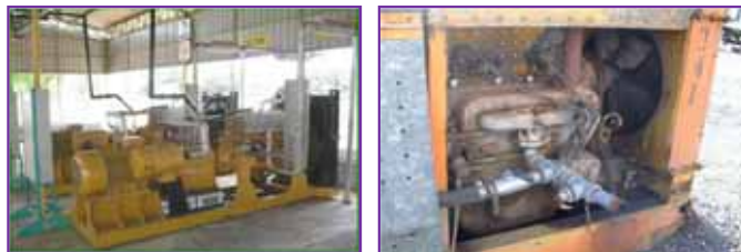
รูปแสดงเครื่องยนต์ดีเซลใช้กับก๊าซชีวภาพรูปเครื่องยนต์ดีเซลเบนซินใช้กับก๊าซชีวภาพ
