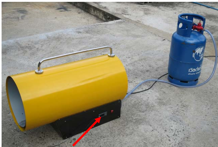
รูปที่ A4 อุปกรณ์ควบคุมอุณหภูมิของเครื่องเผาไหม้แก๊ส
