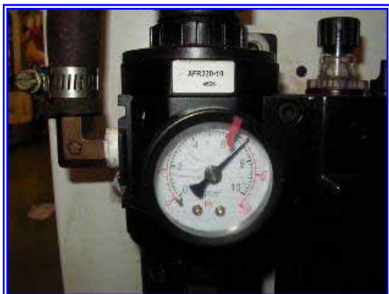
รูปที่ 6.1-2 การตั้งความดันที่เครื่องและความดันใช้งานสูงสุดในกระบวนการผลิตก่อนปรับปรุง
