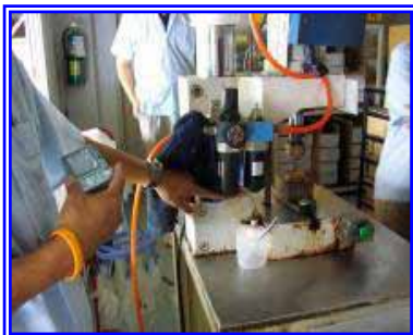
ข้อต่อท่อลมและรูเจาะของชุด AR เครื่องปั๊มสูญ PD-233
