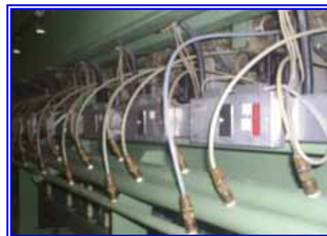
รูปที่ 6.2-16 สภาพหลังการปรับปรุง จุดที่มีการรั่วไหลของอากาศอัดจากเครื่องกรอตัด
