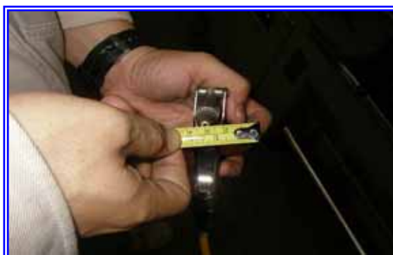
รูปที่ 6.4-6 ปืนลมขนาด 3 มิลลิเมตร หลังปรับปรุง
