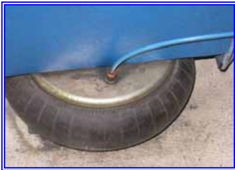
รูปที่ 6.2-11 สภาพหลังการปรับปรุงอากาศอัดรั่วในระบบอากาศอัด
