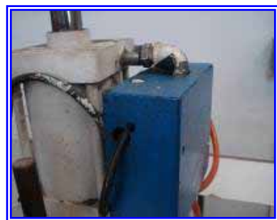
เปลี่ยนข้อต่อท่อกับชุด Direction Control ของเครื่องปั๊มสุญ 12
