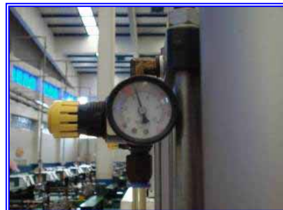
รูปที่ 6.1-2 การตั้งความดันที่เครื่องและความดันใช้งานสูงสุดในกระบวนการผลิตก่อนปรับปรุง
