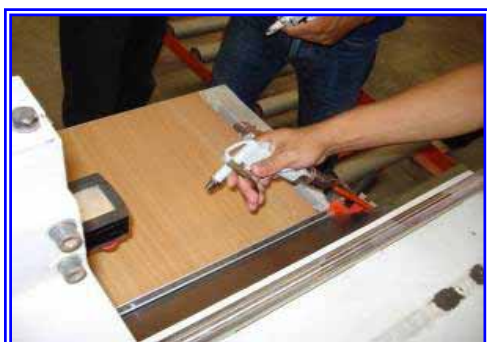
รูปที่ 6.4-15 หลังปรับปรุงใช้ปืนลมเป่าความสะอาด หัวขนาด 1 มิลลิเมตร
