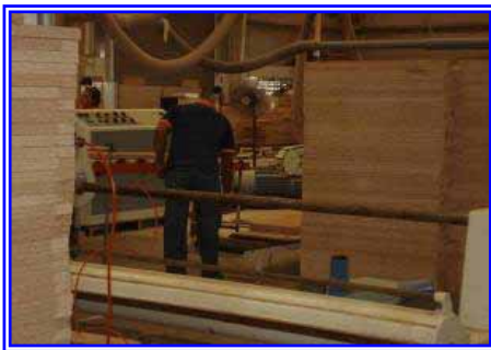
รูปที่ 6.4-13 ลักษณะการใช้อากาศอัดเป่าทำความสะอาดจากสายยาง
