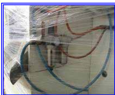
หลังปรับปรุงถอดเปลี่ยนซีลเกลียวด้านบน ชุด AR เครื่องอัดสูญ PS118
