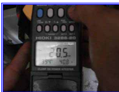
กำลังไฟฟ้าในช่วงไม่มีโหลดของเครื่องอัดอากาศ No.4
