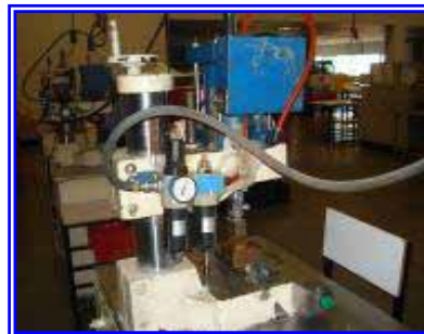
ข้อต่อท่อลมยางชุด Air Service ของปั๊มสูญ 6
