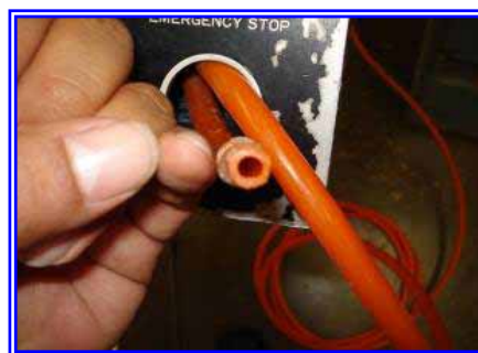
รูปที่ 6.4-14 การใช้สายยางเป่าความสะอาด
