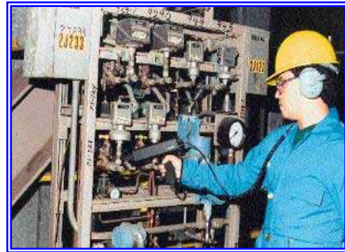
รูปที่ 6.2-12 การใช้ Ultrasonic leak detector ตรวจสอบการรั่วไหลอากาศอัด
