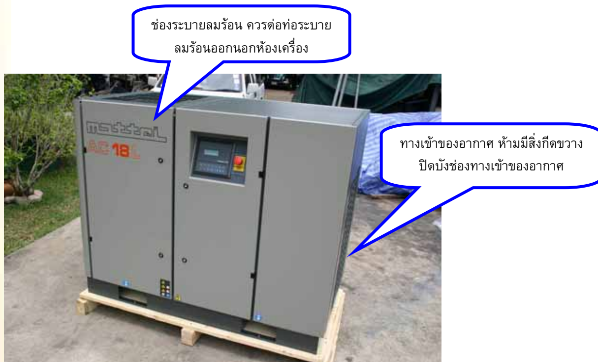
รูปที่ 4.1-3 การตรวจสอบบริเวณทางเข้าออกของอากาศ
