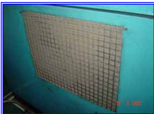
รูปที่ 6.1-22 ชุดกรองอากาศก่อนเข้าเครื่องอัดอากาศที่ขาดการดูแลบำรุงรักษาที่ดี
