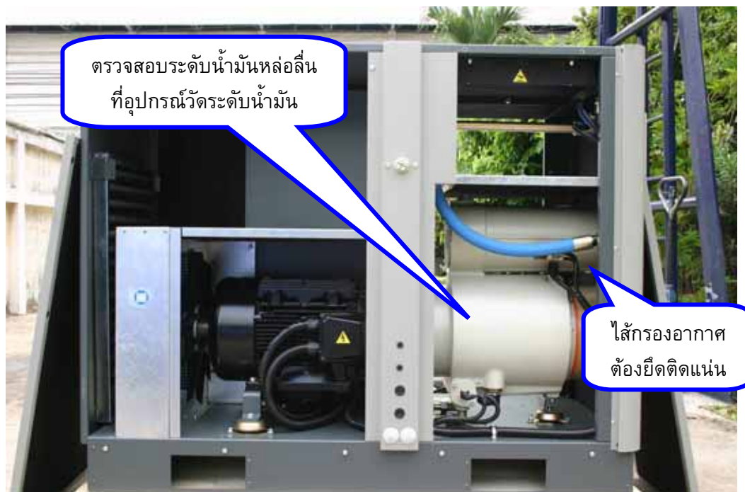
รูปที่ 4.1-2 ส่วนประกอบที่ควรตรวจเช็คก่อนการเดินเครื่อง
