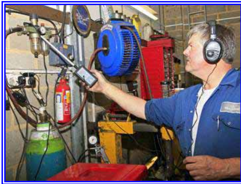
รูปที่ 6.2-12 การใช้ Ultrasonic leak detector ตรวจสอบการรั่วไหลอากาศอัด
