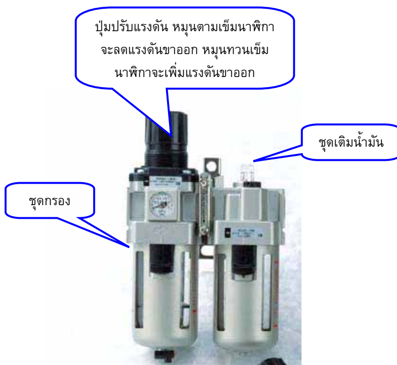
รูปที่ 3.3-6 ชุดกรองอากาศ-ชุดปรับแรงดัน-ชุดป้อนน้ำมันหล่อลื่น
