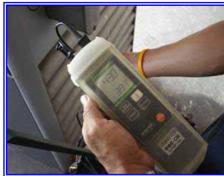
อุณหภูมิอากาศเข้าเครื่องอัดอากาศ No. 4 มีค่า 39.1 องศาเซลเซียส
