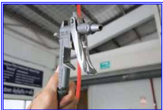
รูปที่ 6.4-5 ปืนลมขนาด 8 มิลลิเมตร ก่อนปรับปรุง
