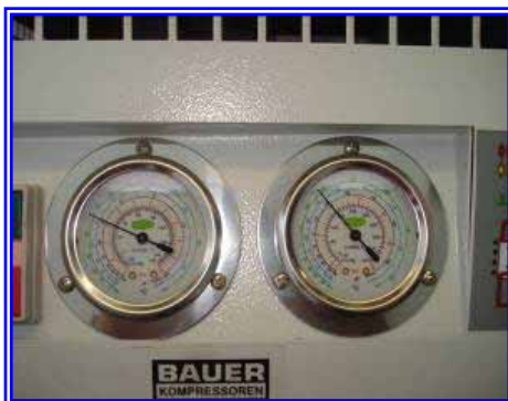
รูปที่ 6.2-4 Dew Point ของอากาศอัดขณะใช้งานจริง
