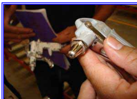
รูปที่ 6.4-15 หลังปรับปรุงใช้ปืนลมเป่าความสะอาด หัวขนาด 1 มิลลิเมตร
