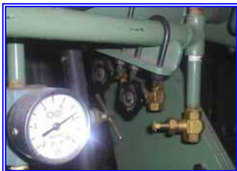
รูปที่ 6.2-16 สภาพหลังการปรับปรุง จุดที่มีการรั่วไหลของอากาศอัดจากเครื่องกรอตัด
