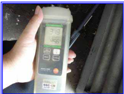
อุณหภูมิอากาศเข้าเครื่องอัดอากาศ No. 5 มีค่า 45.6 องศาเซลเซียส
