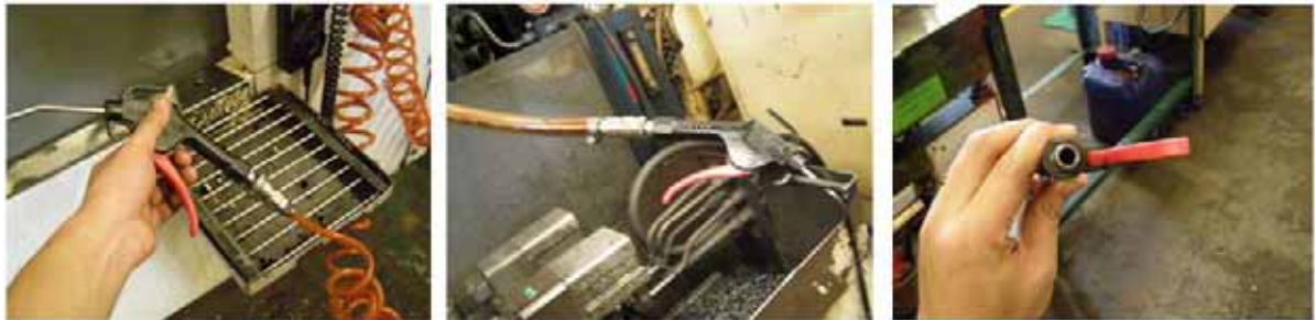
รูปที่ 6.4.-3 ขนาดหัวปืนลมที่ใช้ก่อนปรับปรุง ขนาด 5 มิลลิเมตร
