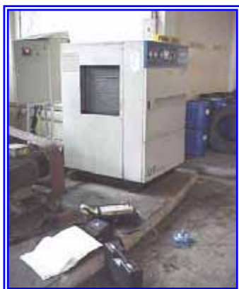
รูปที่ 6.1-12 การติดตั้ง VSD ควบคุมความเร็วรอบเครื่องอัดอากาศ
