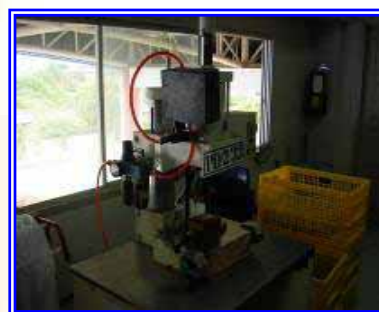
หลังปรับปรุงเปลี่ยนข้อต่อท่อลมและถอดล้าง ชุด AR เครื่องปั๊มสุญ PD-233
