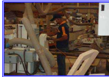
รูปที่ 6.4-13 ลักษณะการใช้อากาศอัดเป่าทำความสะอาดจากสายยาง
