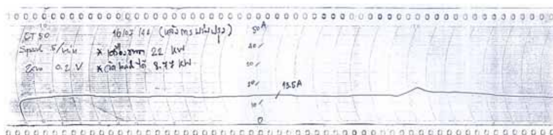
รูปที่ 6.1-15 กราฟแสดงหลังการติดตั้งเครื่องควบคุมความเร็วรอบ
