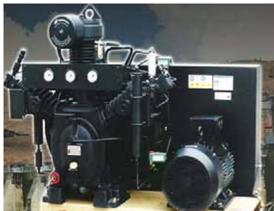
รูปที่ 2.3-5 เครื่องอัดอากาศแบบไดอะแฟรมและแบบลูกสูบ Double Acting
