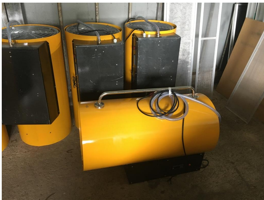
รูปที่ 38 ตัวอย่างเครื่องเผาไหม้แก๊สที่นำมาใช้ให้กำเนิดความร้อนเสริม
