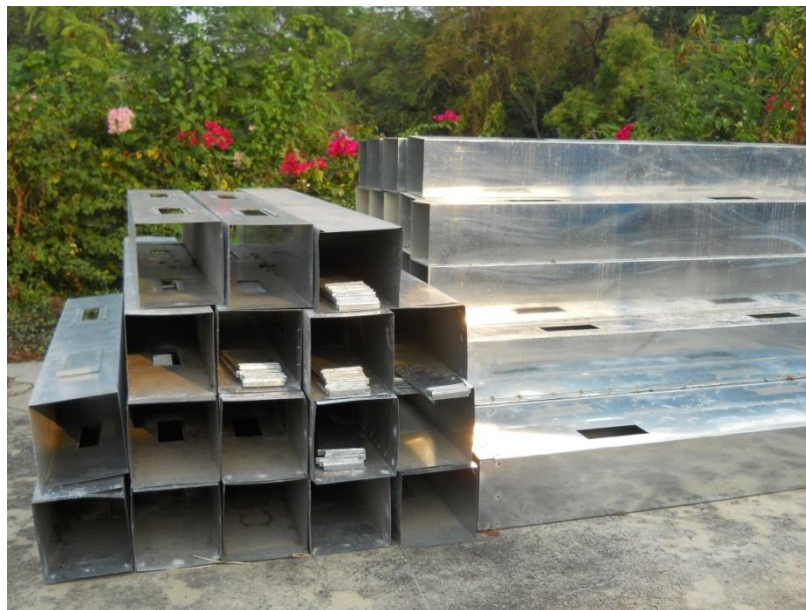
รูปที่ 31 ท่ออากาศที่ใช้ในระบบความร้อนเสริม
