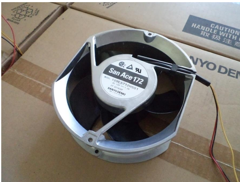
รูปที่ 37 พัดลมไฟฟ้ากระแสตรง 12 โวลต์ ขนาด 14.4 วัตต์
