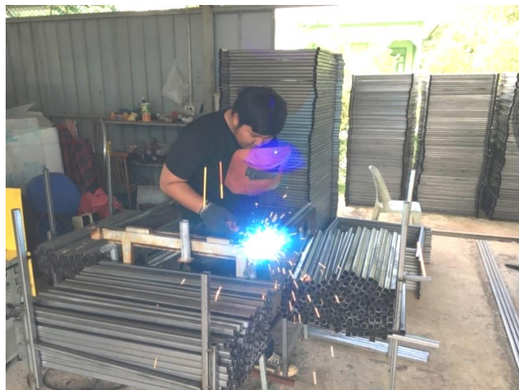
รูปที่ 25 การเตรียมขาเหล็กชั้นวางผลิตภัณฑ์ของระบบบอบแห้ง
