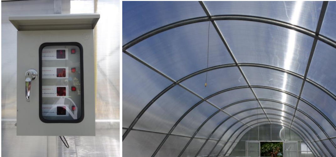
รูปที่ 39 เครื่องวัดอุณหภูมิและความชื้นสัมพัทธ์อากาศภายในและภายนอกระบบบอบแห้งฯ
