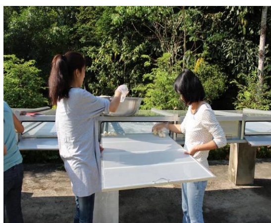
รูปที่ 8 การนำกล้วยไปอบในอุโมงค์ลม
