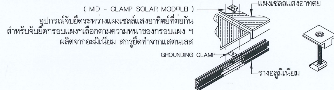
แบบประกอบติดตั้ง MID - CLAMP
