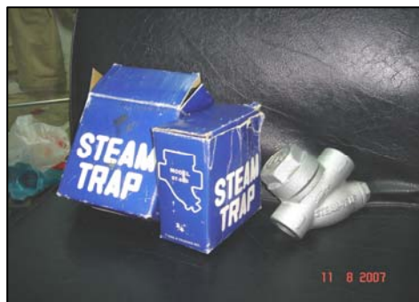
ภาพกับดักไอน้ำใหม่ที่จะดำเนินการติดตั้ง
