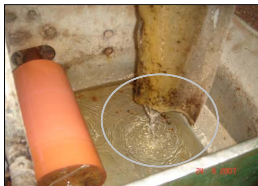
ภาพแสดงน้ำหล่อเย็นส่วนที่มีปริมาณมากเกินไปจนความต้องการ
