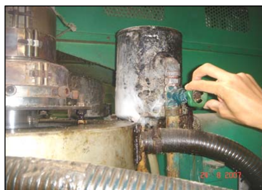
ภาพแสดงการปรับปริมาณน้ำหล่อเย็นให้เหมาะสม
