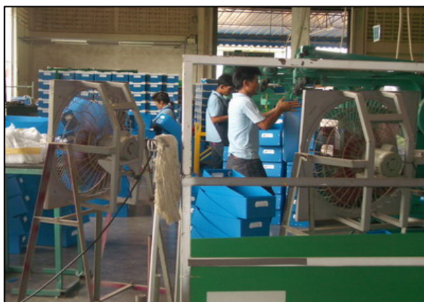
ภาพลักษณะการใช้งานของพัดลมระบายอากาศ
