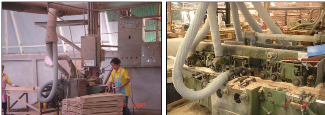
ภาพการทำงาน และเครื่องจักรในแผนกเตรียมประกอบที่ก่อให้เกิดฝุ่นไม้
