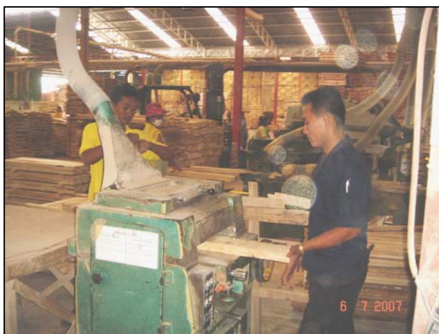
ภาพการไสเปิดหน้าไม้ด้วยเครื่องไส 1 หน้า
