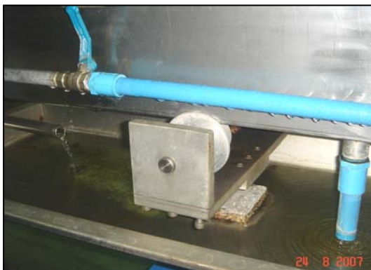
ภาพน้ำที่ล้นจากรางหล่อเย็นหลอดเนื่องจากมีปริมาณน้ำหล่อเย็นมากเกินไปเกินความต้องการ
