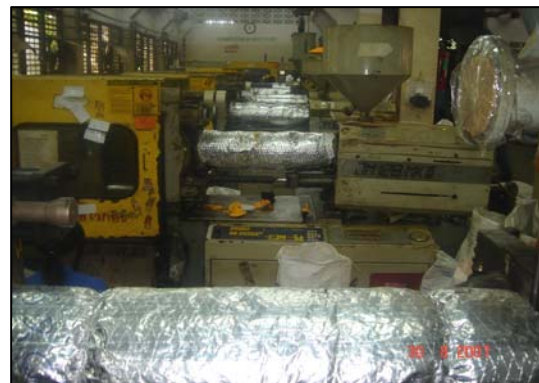
ภาพเครื่องฉีดพลาสติกหลังดำเนินการหุ้มฉนวน
