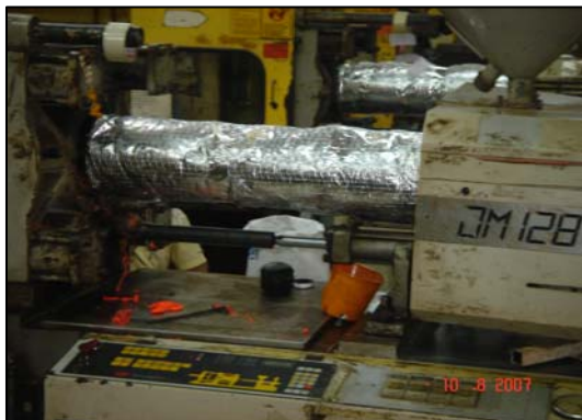
ภาพเครื่องฉีดพลาสติกหลังดำเนินการหุ้มฉนวน
