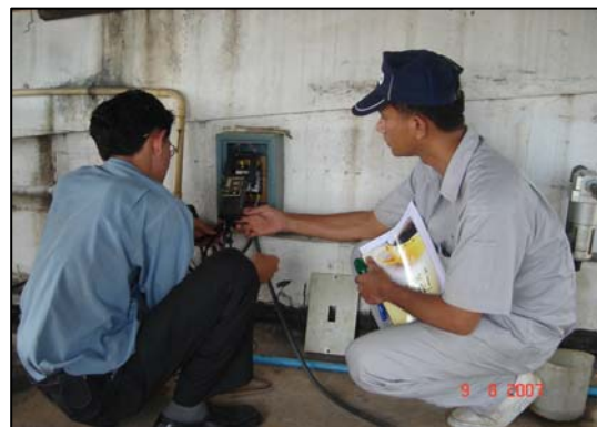
ภาพแสดงการตรวจวัดประสิทธิภาพการผลิตอากาศอัด และพลังไฟฟ้าของเครื่องอัดอากาศหลังปรับปรุง
