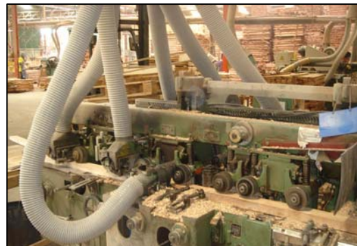
ภาพการไสไม้ด้วยเครื่องไส 4 หน้า
