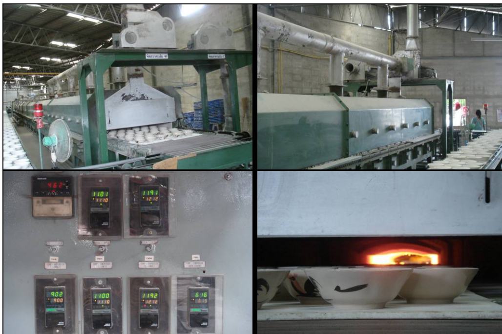
ภาพเตาเผาเซรามิกอุณหภูมิใช้งาน 1250 °C
