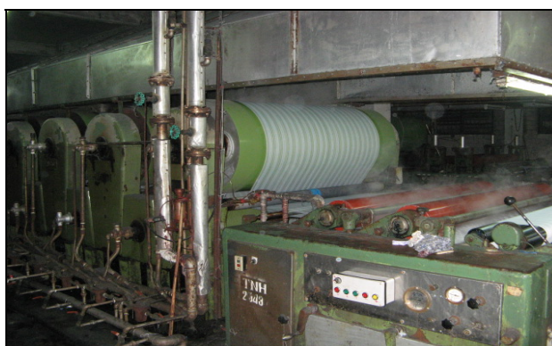
ภาพการใช้ไอน้ำในการอบแห้งเส้นด้ายบริเวณเครื่องลงแป้ง
