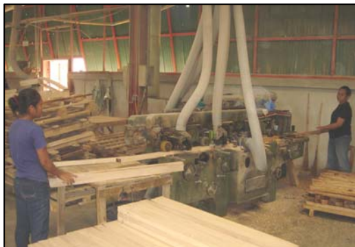
ภาพการไสไม้ด้วยเครื่องไส 4 หน้า
