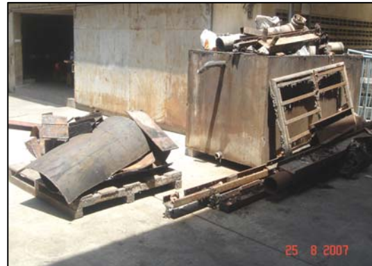
ภาพท่อคอนเดนเสทเจาะรูบริเวณก้นถังน้ำป้อนใหม่ และซากถังน้ำป้อน และอุปกรณ์ประกอบเดิม
