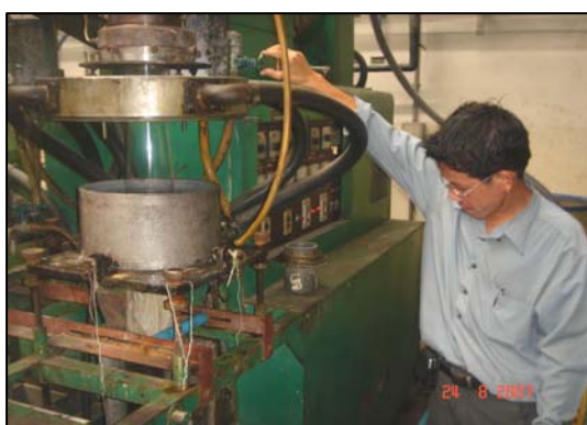
ภาพแสดงการปรับปริมาณน้ำหล่อเย็นให้เหมาะสม
