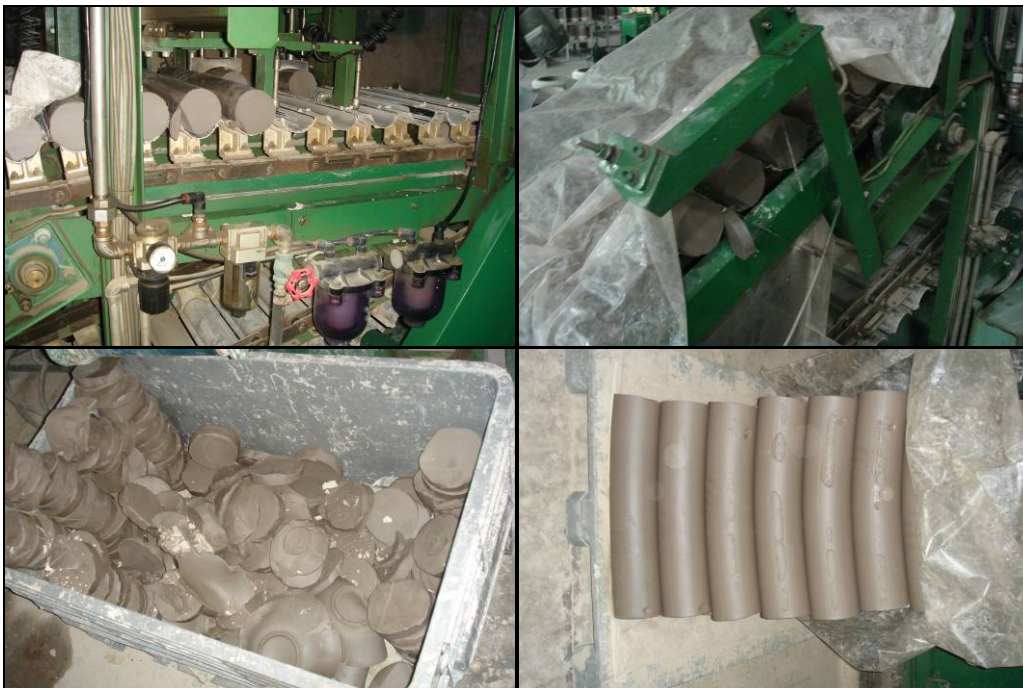
ภาพแสดงเครื่องขึ้นรูปดินและแท่งดินส่วนเกินที่ถูกตัดทิ้ง
