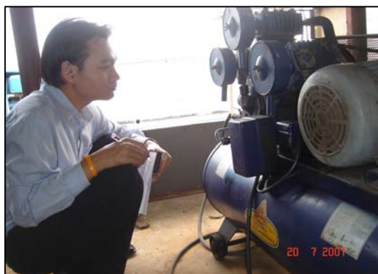
ภาพขณะจับเวลาการผลิตอากาศอัดของเครื่องอัดอากาศ
