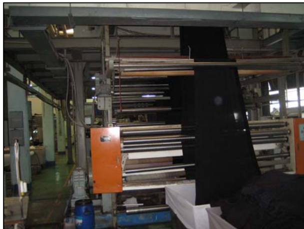
ภาพมอเตอร์เครื่อง Stenter อบแห้ง
