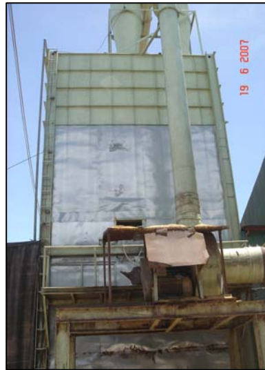
ภาพและท่อลมดูดฝุ่นที่ติดตั้งใช้งานก่อนการปรับปรุง
