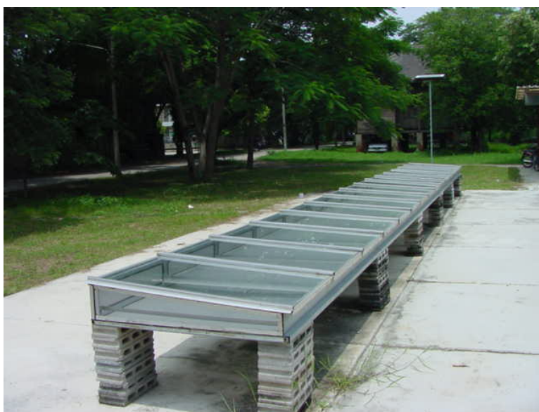
รูปที่ 1.13 แสดงเครื่องอบแห้งพลังงานแสงอาทิตย์แบบอุโมงค์ลมที่ติดตั้งเสร็จเรียบร้อยแล้ว
