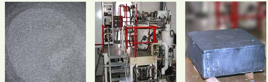
รูปที่ 5.2-6 ผลึกเซลล์แสงอาทิตย์ที่ผ่านการกัดชั้นป้องกันการสะท้อนแสงแล้วถูกนำมาหลอมใหม่อีกครั้ง
