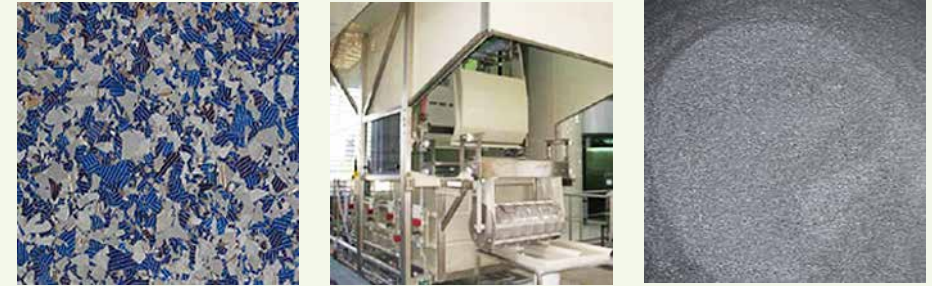
รูปที่ 5.2-5 เซลล์แสงอาทิตย์ที่ผ่านการกัดชั้นป้องกันการสะท้อนแสงของเซลล์แสงอาทิตย์ชนิดผลึกซิลิคอน
