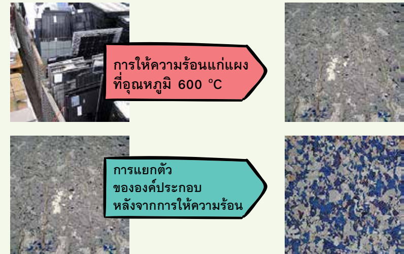
รูปที่ 5.2-2 แผงเซลล์แสงอาทิตย์ที่ถูกนำไปเผาด้วยความร้อน 600 องศาเซลเซียส ที่มา : https://www.bnl.gov
